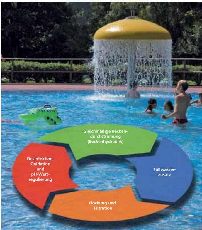
Die Grafik links zeigt die Verzahnung der einzelnen Maßnahmen zur Schaffung und Erhaltung von einwandfreiem Schwimmbeckenwasser: Versagt eine dieser Maßnahmen oder wird sie gar bewusst vernachlässigt, können die anderen, -auch bei optimaler Wirkung-, einer raschen Verschlechterung der Wasserqualität nicht Einhalt gebieten: Die Kette ist eben nur so stark wie ihr schwächstes Glied!
