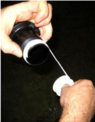
Nehmen Sie das kurze, schwarze Rohr und wickeln Sie das Gewinde davon mit ausreichend Teflonband ein - dabei ist die Wickelrichtung im Uhrzeigersinn entscheidend, da beim Einschrauben sonst das Teflon wieder abgelöst wird.
