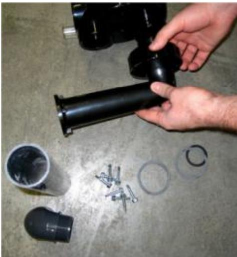
Geben Sie jetzt, ähnlich wie beim vorherigen Schritt, die zweite Überwurf-Mutter auf den Winkel / Knie mit der langen und der kurzen Seite. Die kurze Seite des Winkels, dient zur Verklebung am 6-Wege-Ventil. Das Stück wird unter dem 6-Wege-Ventil in die offene Aussparung geklebt - geben Sie dabei Kleber auf das Rohr und in die Aussparung im 6-Wege-Ventil. Vorher reinigen!
