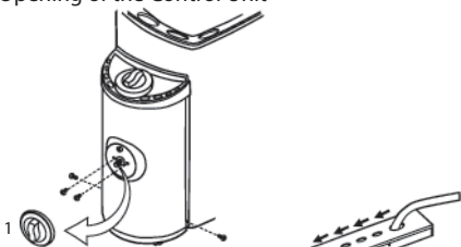
Abb. 3A Fig. 3A Öffnen des Steuergeräts Opening of the Control Unit
