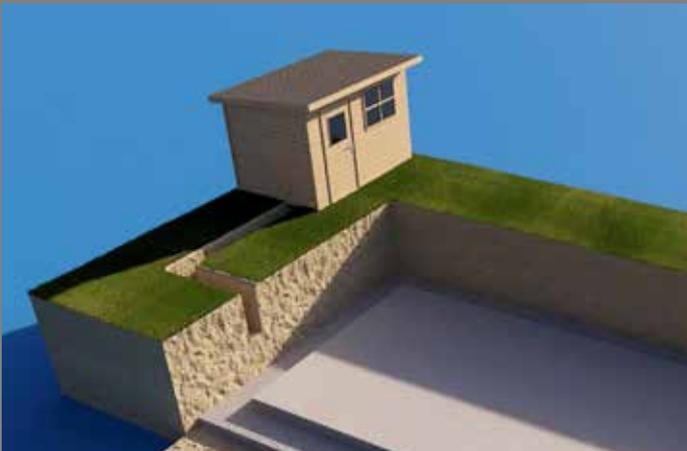
Bei einem oberirdischen Standort der Technik in einem Gartenhaus etc. ist es erforderlich, zu dieser Stelle eine Aussparung mit einer Breite von mindestens 40 cm und einer Tiefe von mindestens 90 cm vorzubereiten (Bild 20).
