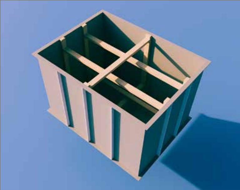
Bild 17: Schacht - Versteifung vor der Hinterfüllung
