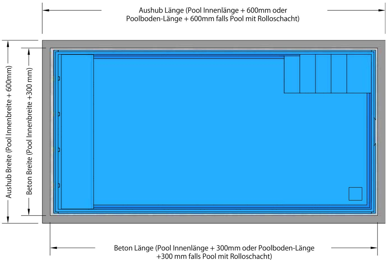
Bild 2a: Aushub ohne Schacht - Maße
