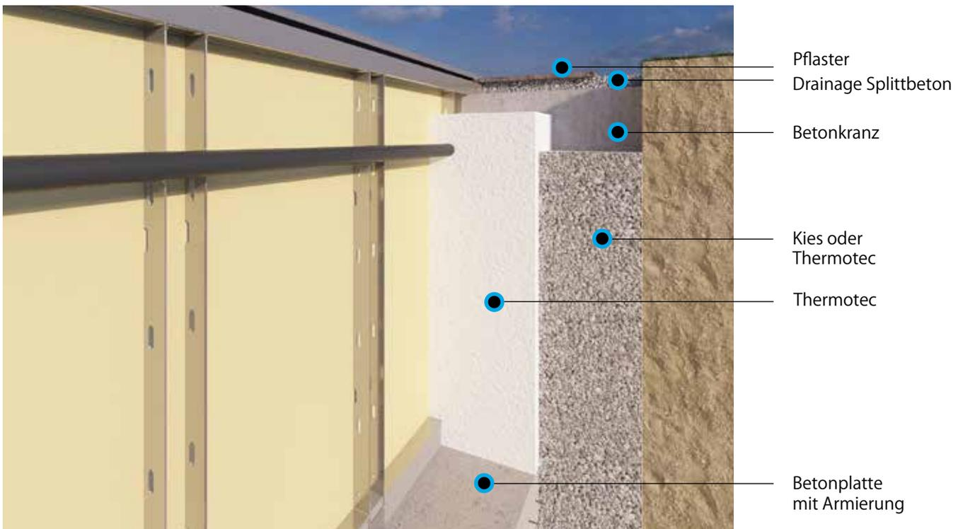
Bild 21: Hinterfüllung der Baugrube mit isolierendem Thermotec-Leichtbeton
