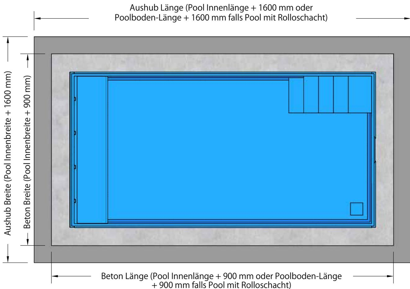
Bild 5a: Aushub ohne Schacht - Maße
