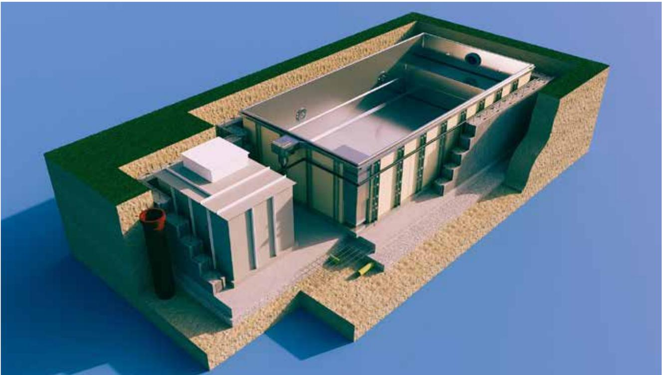
Bild 1: Pool mit Technischacht - Gesamtblick
