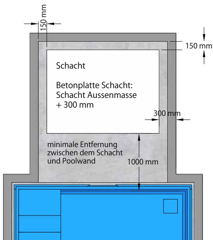
Bild 4a: Aushub mit Schacht - Maße der Schacht-Betonplatte
