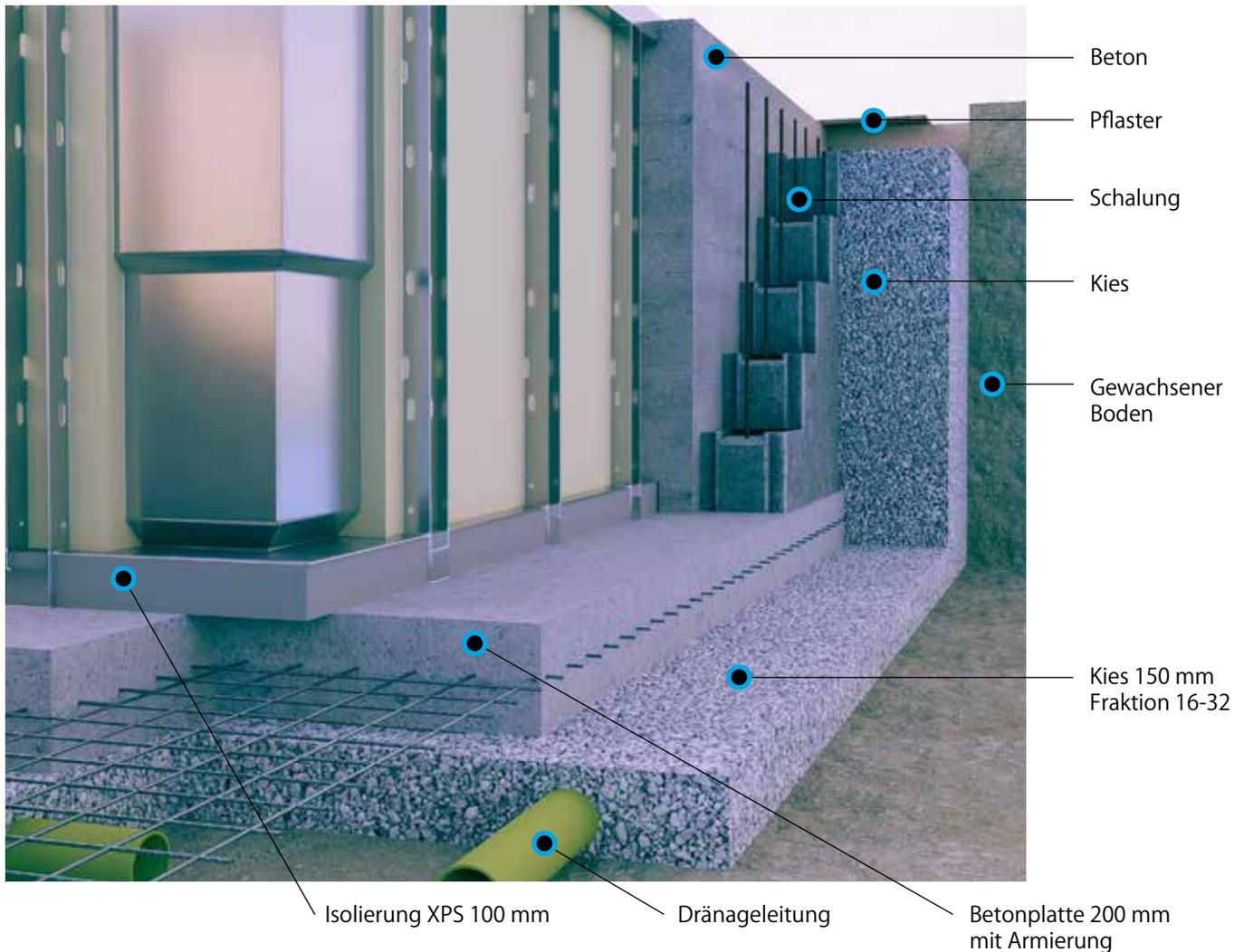
Bild 8: Aushub, einzelnen Schichten - Visualisierung
