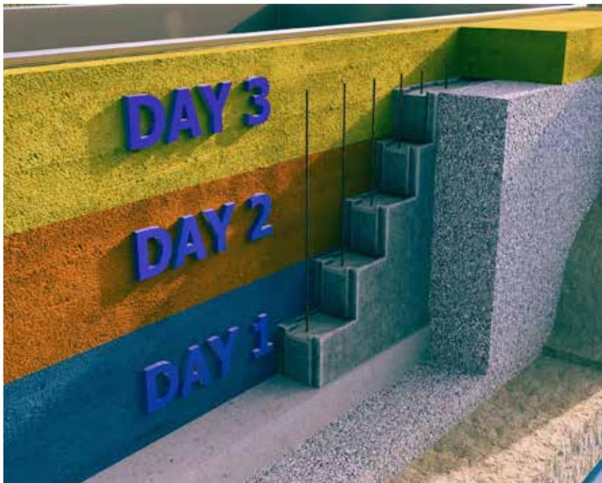
Bild 19: Pool Hinterfüllung mit trockenem Beton in 3 Tagen
