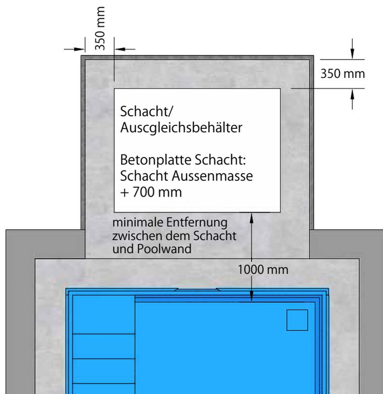
Bild 6a: Aushub mit Schacht - Maße der Schacht-Betonplatte
