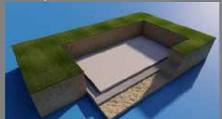
Bild 5b: Aushub ohne Schacht - einzelne Schichten
